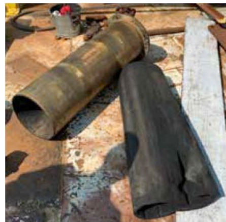
Pryžová ložiska se kvůli své nižší mechanické obvykle vlepují do kovového nosiče. Špatný lepený spoj může vést k tomu, že se ložisko postupně uvolní z nosiče.
